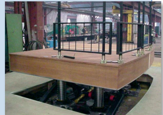
Table élévatrice pour gradin d'orchestre - essais du prototype dans les Ateliers de BC > position haute
