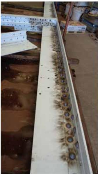
Dans les ateliers de Châteauneuf sur Loire, la fabrication des 2 éléments de poutre neuve a été l'occasion de refaire des opérations de rivetage.
