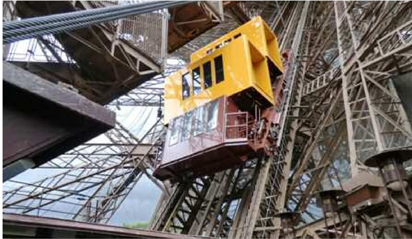
Véhicule en voie - 2 cabines passagers / 1 cabine pilote
