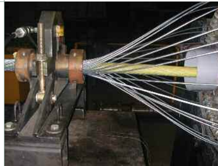
1- OPÉRATION DE CÂBLAGE AVEC UNE PROTECTION INTERNE À LA CIRE PÉTROLIÈRE
