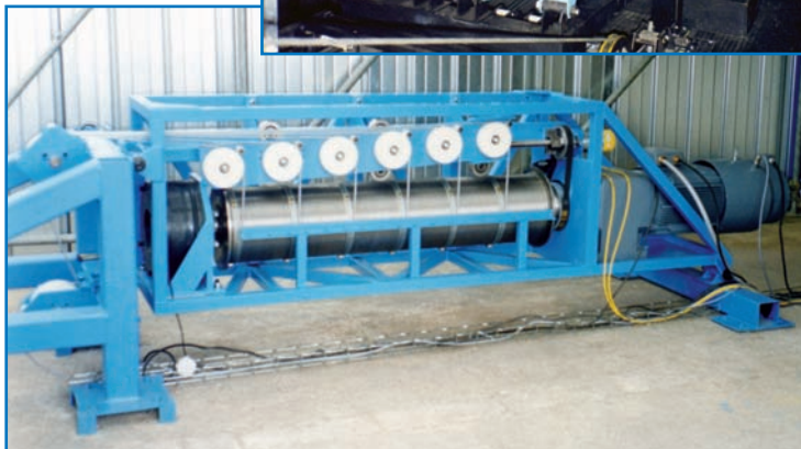
Treuil scénique sur banc d'essai dans les ateliers de BC
